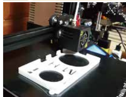
【上】「崇ちゃん」は崇化館交流館のカウンターに置いてあります。 【右】フィラメントが溶けて噴出。ノズルが行き来してスマホのケースを作っています。
